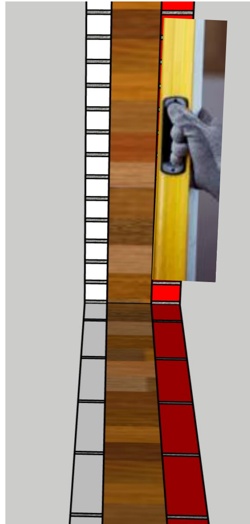
Verticaal waterpas in deze richting
